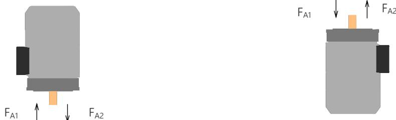
Standardausführung mit Rillenkugellager
